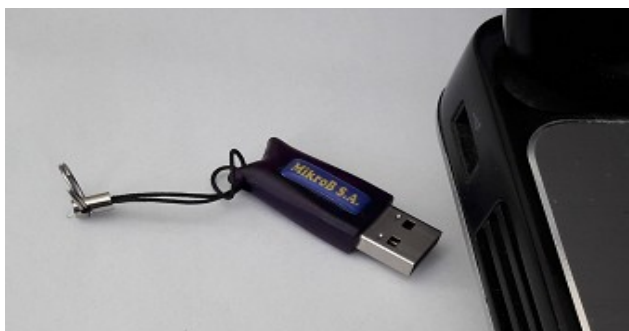
Ilustracja 2.3: Klucz sprzętowy z licencją PRO-2000
